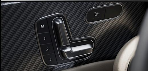
Paquete de memorias del ajuste de asientos hasta para 3 personas diferentes, además de poder modificar la posición del asiento de forma eléctrica. Disponible únicamente para el asiento del conductor.
