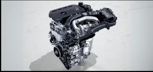
Motor accionado por correa (RSG) con sistema eléctrico 48 V, que entrega 13 HP de potencia y 150 Nm de torque que apoyan al motor de combustión, reduciendo el consumo de combustible y aumentando las prestaciones del vehículo.
