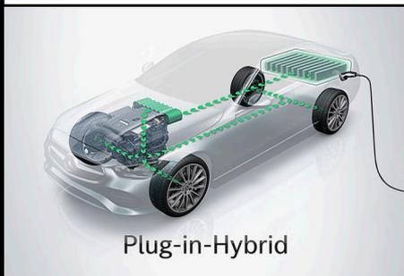
Motor Híbrido Enchufable con potencia combinada de 309 HP, 550 Nm de torque y autonomía de 102-117 Km. La autonomía dependerá de los hábitos de manejo del conductor.
