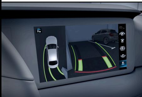
Cuatro cámaras conectadas en red proporcionan imágenes del entorno para los correspondientes laterales del vehículo, manteniendo una visualización óptima y mostrando la perspectiva adecuada de todos los lados del vehículo.
