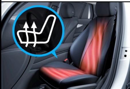
La calefacción de asiento ajusta con rapidez una temperatura agradable de los asientos del conductor y del copiloto. La intensidad se selecciona en 3 niveles. Transcurrido un tiempo, la calefacción de asiento cambia automáticamente a un nivel más reducido.
