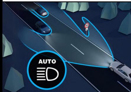
Más visibilidad, menos deslumbramiento. Esta es la máxima en la que se basan las luces de carretera automáticas Plus. Este inteligente sistema utiliza diodos luminosos de alta precisión y excluye del cono luminoso a los vehículos que circulan por delante o en sentido contrario. De ese modo no tiene que cambiar constantemente a la luz de cruce.
