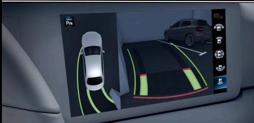
Cuatro cámaras conectadas en red proporcionan imágenes del entorno para los correspondientes laterales del vehículo, manteniendo una visualización óptima y mostrando la perspectiva adecuada de todos los lados del vehículo.
