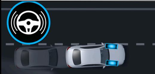
El detector activo de cambio de carril es un observador atento. Si abandona su carril por inadvertencia o se aproxima peligrosamente a otros usuarios de la vía, el sistema puede reaccionar con una intervención en la dirección para regresarlo a su carril. Si a pesar de ello abandona su carril, el sistema le advierte mediante la vibración del volante.
