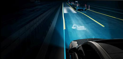
DIGITAL LIGHT adapta constantemente la iluminación de la vía en función de la luz que haya y en función del tránsito, la calzada y las condiciones meteorológicas. El sistema HD funciona como un proyector y calcula la iluminación con precisión de píxeles.
