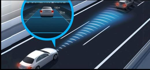
El asistente de distancia DISTRONIC facilita considerablemente la tarea del conductor al volante, ya que regula de forma automática la distancia con respecto al vehículo de en frente. Además, aproximándose a una curva el sistema reduce de forma anticipada la velocidad.
