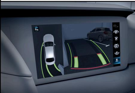
Cuatro cámaras conectadas en red proporcionan imágenes del entorno para los correspondientes laterales del vehículo, manteniendo una visualización óptima y mostrando la perspectiva adecuada de todos los lados del vehículo.
