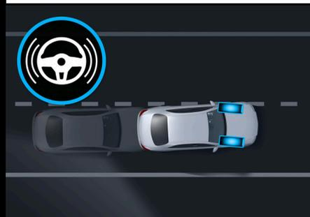
El detector activo de cambio de carril es un observador atento. Si abandona su carril por inadvertencia o se aproxima peligrosamente a otros usuarios de la vía, el sistema puede reaccionar con una intervención en la dirección para regresarlo a su carril. Si a pesar de ello abandona su carril, el sistema le advierte mediante la vibración del volante.
