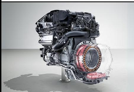
Motor arrancador integrado (ISG) con sistema eléctrico 48 V, que entrega 23 HP de potencia y 200 Nm de torque que apoyan al motor de combustión, reduciendo el consumo de combustible y aumentando las prestaciones del vehículo.
