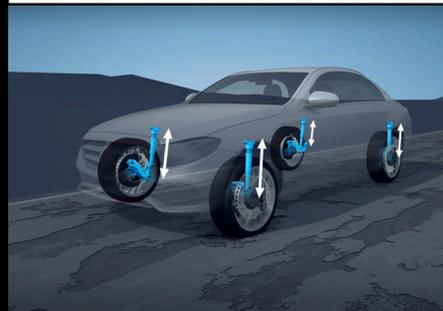
Gracias a la regulación neumática de nivel en las cuatro ruedas, el vehículo conserva siempre su altura, con independencia de la carga. A alta velocidad disminuye la altura del vehículo con el fin de reducir la resistencia aerodinámica y aumentar la estabilidad.
